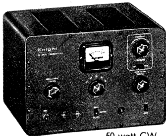
50-watt CW Transmitter
