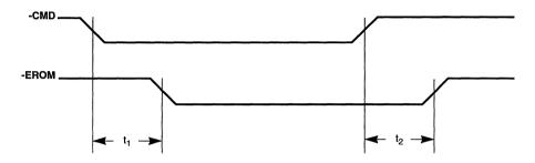
Figure 7–19. -EROM Timing (MicroChannel<sup>®</sup> Bus)
