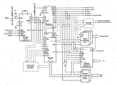
FIGURE 31. BASIC 80C286 SYSTEM CONFIGURATION
