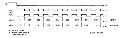
Fig. 4 - Control byte.
