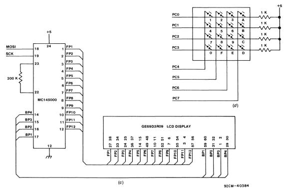
Fig. 1 - cont'd -(c) LCD display, (d) keypad.
