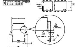
(D) SUFFIX (JEDEC MS-015-AD) 18 LEAD DUAL-IN-LINE SIDEBRAZED CERAMIC PACKAGE
