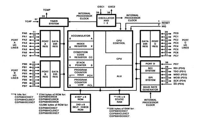
FIGURE 1-1. MICROCOMPUTER BLOCK DIAGRAM.
