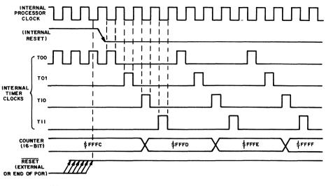
NOTE: THE COUNTER REGISTER AND TIMER CONTROL REGISTER ARE THE ONLY ONES AFFECTED BY RESEY.
