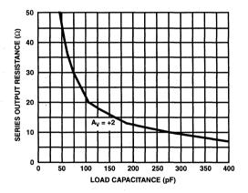
FIGURE 1. RECOMMENDED SERIES OUTPUT RESISTOR vs LOAD CAPACITANCE
