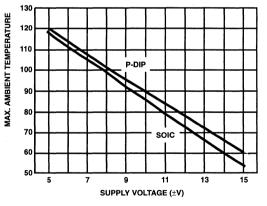
FIGURE 7. MAXIMUM OPERATING AMBIENT TEMPERATURE vs SUPPLY VOLTAGE
