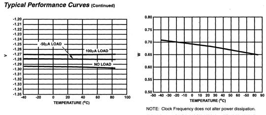
FIGURE 16. REFERENCE VOLTAGE vs TEMPERATURE
