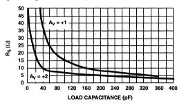
FIGURE 1. RECOMMENDED SERIES RESISTOR vs LOAD CAPACITANCE
