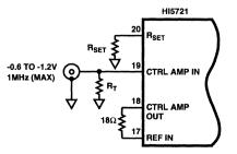
FIGURE 19. LOW FREQUENCY MULTIPLYING CIRCUIT
