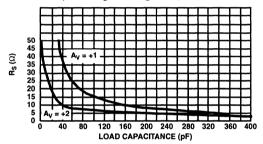
FIGURE 1. RECOMMENDED SERIES OUTPUT RESISTOR vs LOAD CAPACITANCE
