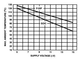
FIGURE 7. MAXIMUM OPERATING AMBIENT TEMPERATURE vs SUPPLY VOLTAGE
