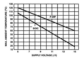
FIGURE 7. MAXIMUM OPERATING AMBIENT TEMPERATURE vs SUPPLY VOLTAGE
