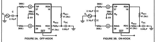
FIGURE 3. LONGITUDINAL CURRENT LIMIT
