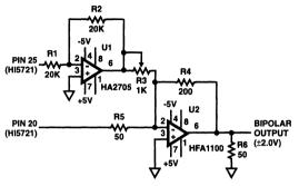
FIGURE 24. BIPOLAR OUTPUT CONFIGURATION
