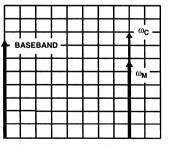
FIGURE 7C. ZERO IF OR DIRECT DOWN CONVERSION
