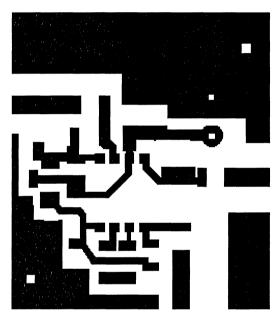
FIGURE 10. UP/DOWN CONVERTER LAYOUT, 400%. MATERIAL G10, 0.031
