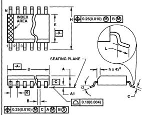
POWER SOP PACKAGE (HEAT SLUG SURFACE IS ELECTRICALLY FLOATING)
