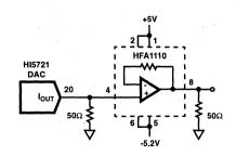
FIGURE 23. HIGH SPEED CURRENT TO VOLTAGE CONVERSION
