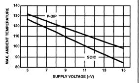
FIGURE 7. MAXIMUM OPERATING AMBIENT TEMPERATURE vs SUPPLY VOLTAGE
