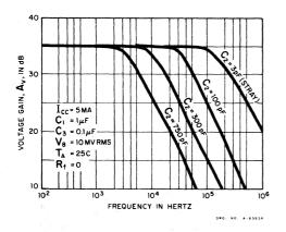
Figure 6 VOLTAGE GAIN FOR VARIOUS FEEDBACK CAPACITORS AS A FUNCTION OF FREQUENCY
