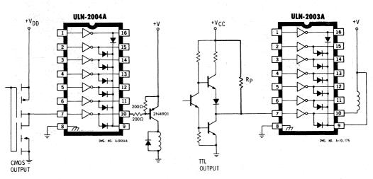
USE OF PULL-UP RESISTORS TO INCREASE DRIVE CURRENT
