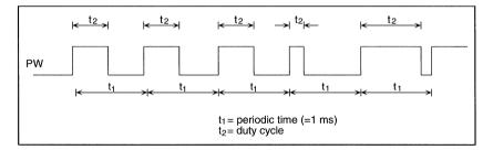
Figure 7.4: PWM Modulation
