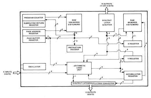
FIGURE 3 - TMS 1000/1200 LOGIC BLOCKS
