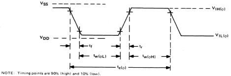
FIGURE 11 - EXTERNALLY DRIVEN CLOCK INPUT WAVEFORM
