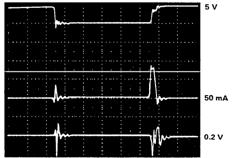
h) SN74AS1000 load: C_L = 50 \text{ pF}
