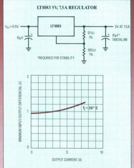
LT1083 DROPOUT VOLTAGE VS. OUTPUT CURRENT
