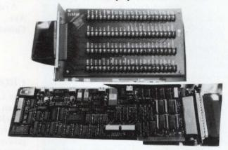
IBM PC\*DATA ACQUISITION AND CONTROL ADAPTER
