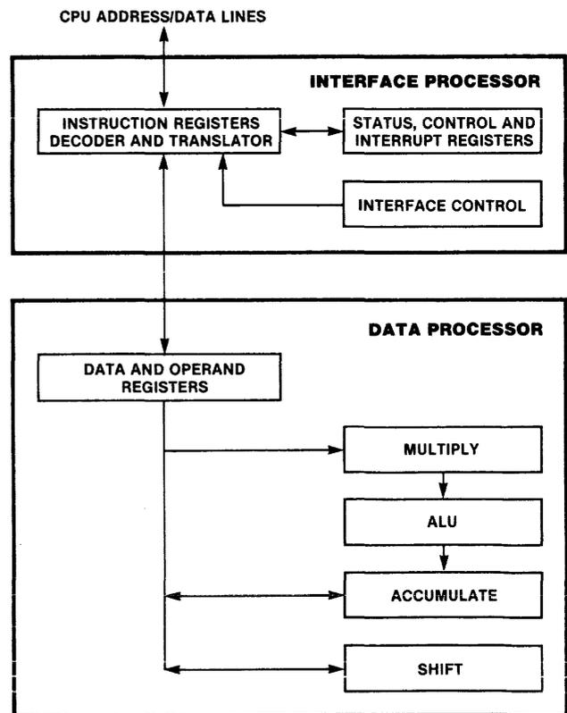
Figure 2—Z8070 Block Diagram
