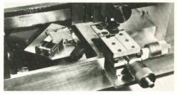
SEMIAUTOMATIC FLIP-CHIP BONDING MACHINE DEVELOPED BY AUTONETICS
