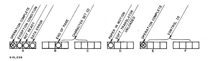
Figure V-3. Printer Test OP Result Descriptor
