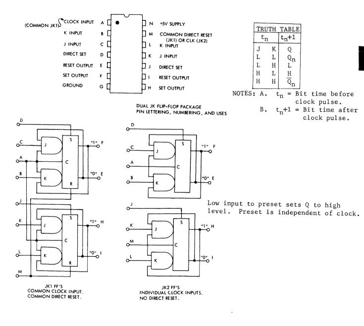
Fig. IIC-109 J-K FLIP-FLOPS
