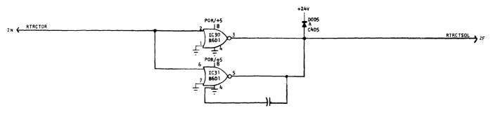
FIG. IIC-125 RETRACT SOLENOID DRIVER
