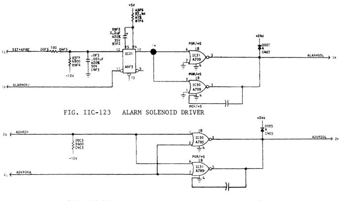
FIG. IIC-124 ADVANCE RIGHT & LEFT SOLENOID DRIVER
