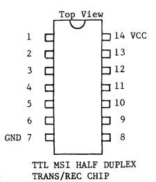
FIG. IIC-115 HALF DUPLEX TRANSMITTER/RECEIVER
