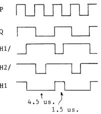
FIG. IIC-141 CLOCK GENERATION
