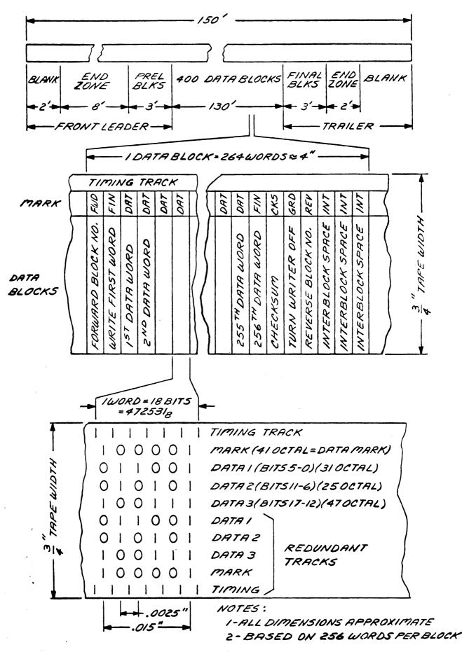
FIGURE 9,1 LINC TAPE FORMAT 10.0 THEORY OF OPERATION
