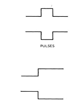
LEVELS, TRANSITION SHOWS DIRECTION OF INITIAL MOVEMENT. LEVEL REMAINS UNTIL OTHER ACTION IS TAKEN.
