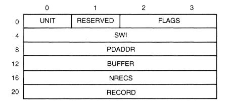
Figure 8-9. WRITE Parameter Block
