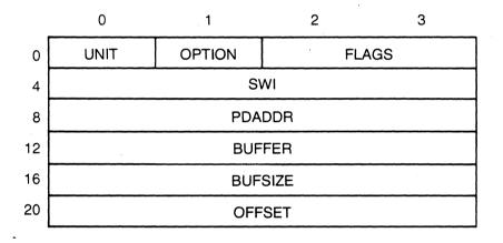
Figure 11-4. WRITE Parameter Block
