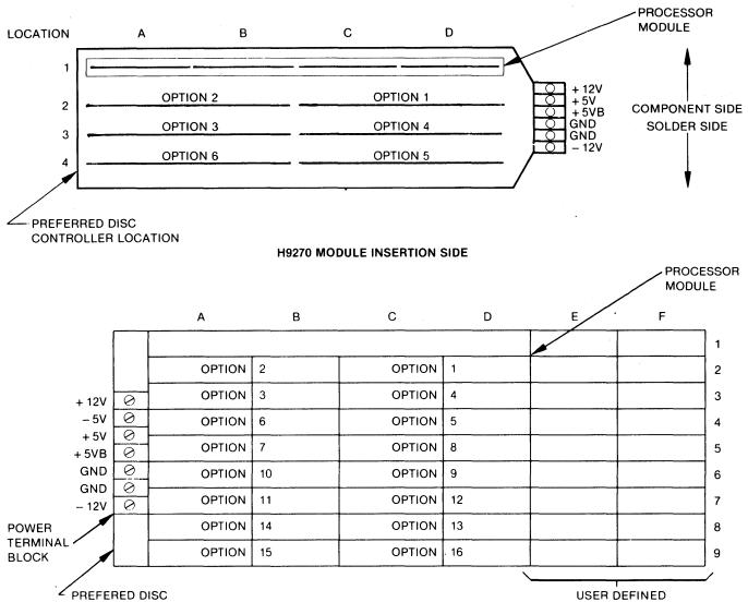
CONTROLLER LOCATION DDV11-B BACKPLANE MODULE INSERTION SIDE SLOTS
