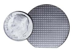
FIGURE 19. MORE THAN 300 CHIPS BEFORE EXTRACTION.
