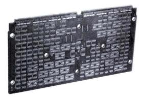
FIGURE 25. LOGIC CIRCUIT BOARD BEFORE ASSEMBLY.
