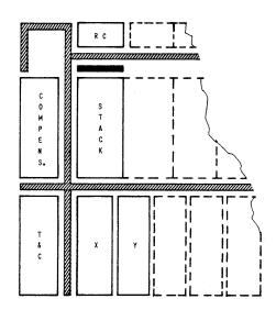
FIGURE 32. EXPANSION SCHEME FOR MEMORY UNIT.
