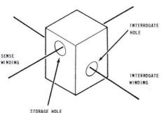
FIGURE 10. THE BIAX ELEMENT SHOWING HOLE LOCATION.
