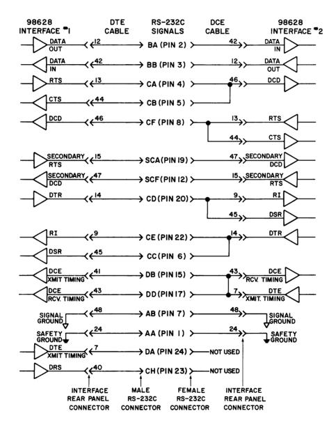
DTE/DCE Interface Cable Wiring
