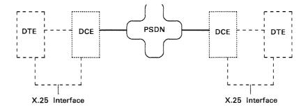
Figure 1-3. The X.25 DTE/DCE Interface
