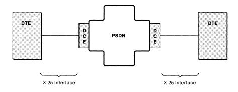
Figure 7. X.25 DTE/DCE Interface
