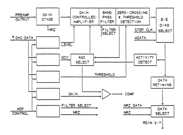
FIGURE 2.4.3.1(a) ADP READ BLOCK DIAGRAM - GCR/PE DENSITIES
