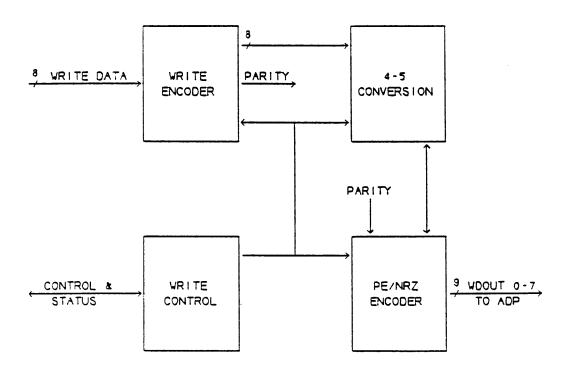
FIGURE 2.5.3.1 DDP WRITE BLOCK DIAGRAM
