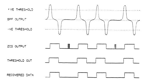
FIGURE 2.4.3.2(b) NRZ READ WAVEFORMS
