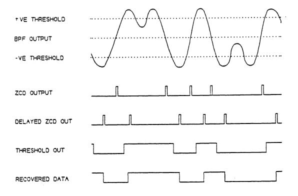
FIGURE 2.4.3.1(b) GCR/PE READ WAVEFORMS
