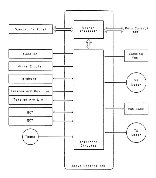
FIGURE 2.2.2 SERVO CONTROL BLOCK DIAGRAM
