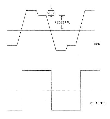
FIGURE 2.4.2(b) WRITE CURRENT WAVEFORMS
