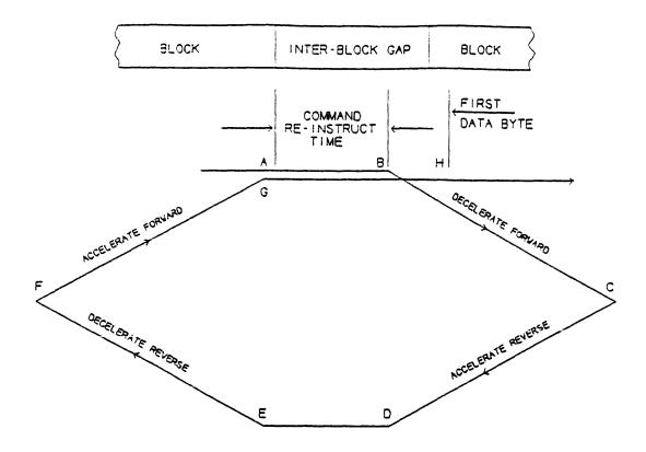
FIGURE 1.4 TYPICAL REPOSITION CYCLE
