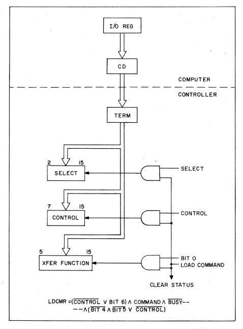
FIGURE 3-6 OUTPUT TO COMMAND REGISTER
