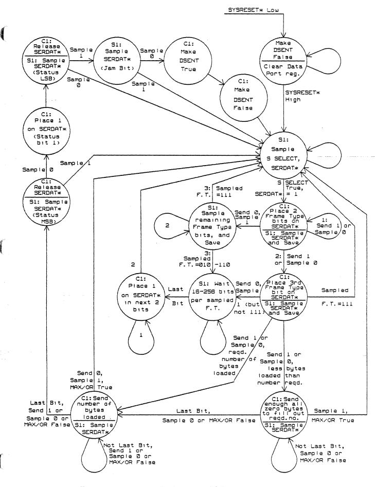
Figure 6-6. DATA SENDER State Diagram
