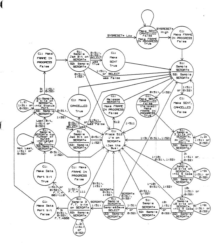
Figure 6-9. FRAME MONITOR State Diagram
