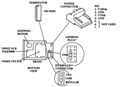
\* ADDRESS PLUG SET FOR MASTER (STAND-ALONE) DKU. SLAVE (EXPANSION) DKU-JUMPER PIN 2 TO COM (COMMON).
