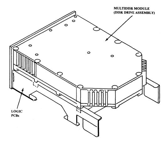
Figure 1-2 Multidisk Module (Disk Drive Assembly)
