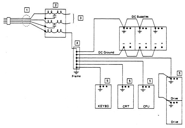
FIGURE 2-3 RECOMMENDED POWER AND GROUND DISTRIBUTION
