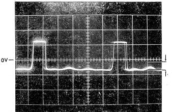
MAXIMUM HEIGHT OF INTERPULSE NOISE MUST BE LESS THAN 25% OF PULSE HEIGHT
