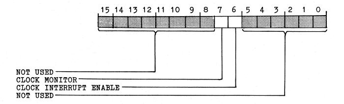
FIGURE 3-5; CSR (177546) CLOCK REGISTER FORMAT
