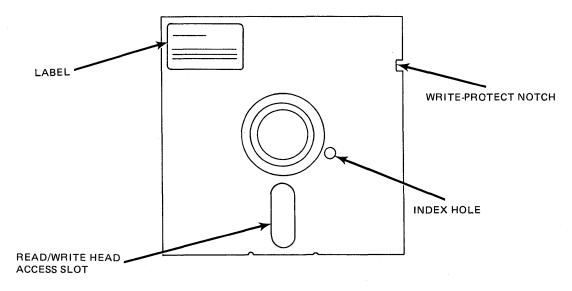
Figure 3–1. 51/4-Inch Diskette Used in the Diskette Subsystem
