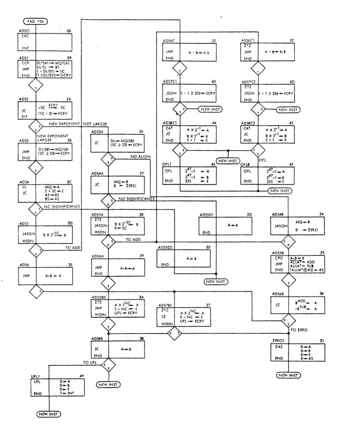
Figure 4-9. FAD/FSB Routine, Flowchart
