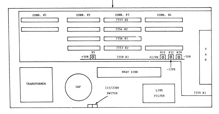
FIGURE 2.1 MODEL 5528 COMMUNICATIONS CONTROLLER
