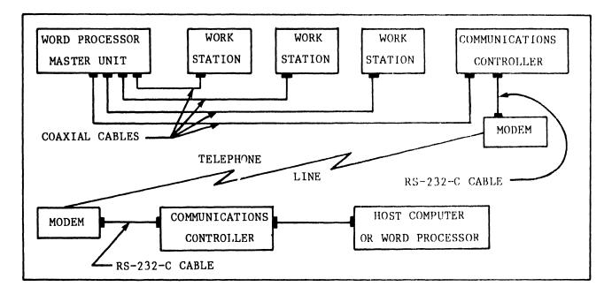
FIGURE 2.3 A TYPICAL BISYNCHRONOUS REMOTE CONNECTION
