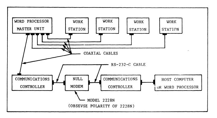
FIGURE 2.4 A TYPICAL BISYNCHRONOUS DIRECT CONNECTION
