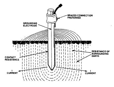
FIGURE 4-5 EARTH GROUND STAKE (Ground Rod)
