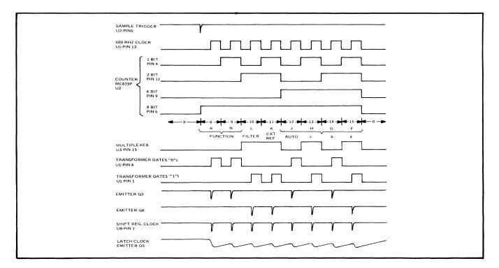
Figure 6-2. REMOTE CONTROL SAMPLE LOAD SEQUENCE
