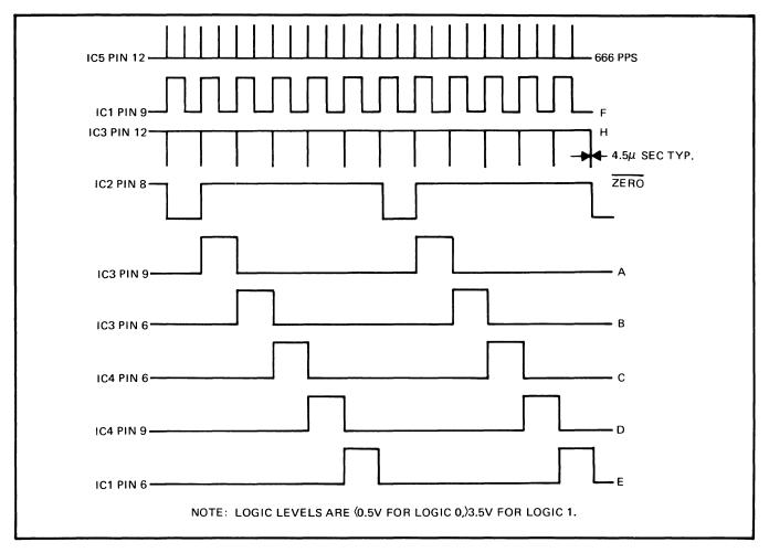
Figure 4-16. SHIFT REGISTER OPERATION
