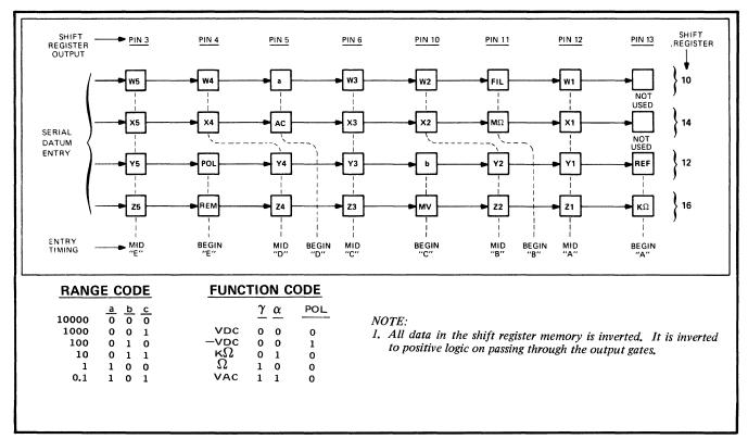
Figure 6-4. SHIFT REGISTER LOAD SEQUENCE
