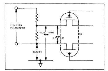
Figure 6-2. VOLTAGE DISTRIBUTION IN MOSFET Q9.
