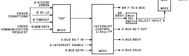
\* THE INTERRUPT CONTROL CIRCUIT IS SIMILAR TO THE M7821 INTERRUPT CONTROL MODULE
