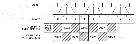
CUT JUMPER FOR A BINARY 1 CUT JUMPERS WAV6, WAV4 AND WAV2 ON THE ODD DATA PATH MODULE CUT JUMPERS WBV6, WBV4 AND WBV2 ON THE EVEN DATA PATH MODULE
