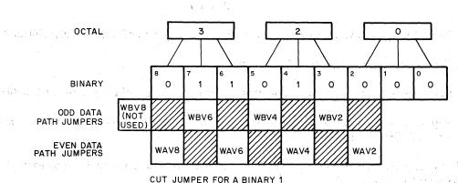
CUT JUMPER WBV6 ON THE ODD DATA PATH MODULE CUT JUMPERS WAV6 AND WAV4 ON THE EVEN DATA PATH MODULE
