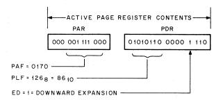
TO SPECIFY PAGE LENGTH FOR A DOWNWARD EXPANDABLE PAGE, WRITE COMPLEMENT OF BLOCKS REQUIRED INTO HIGH BYTE OF PDR.
