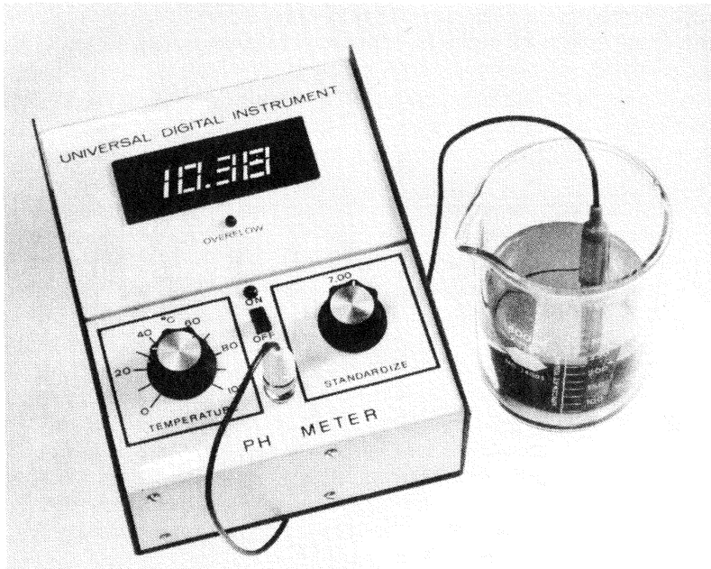
Fig. 7-10. Digital pH meter using a 3130 op amp.
