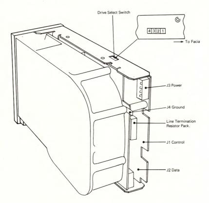
FIGURE 2 J1 Connector – Control
