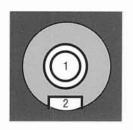
Pin 1 +18V Pin 2 0V
