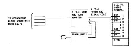
\* IF AC POWER IS NOT FROM A LOCAL AC OUTLET, BUT FROM AN AC POWER STRIP IN A CONNECTING CLOSET, THE POWER IS CONNECTED AT PROPER CONNECTING BLOCK IN THE CLOSET. THE 400B ADAPTER IS THEN NOT REQUIRED.
