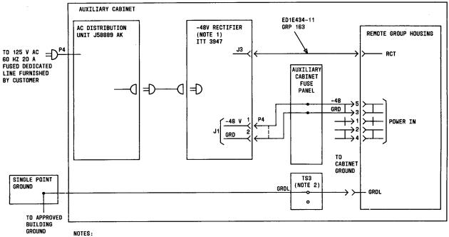
1. THE 48-V RECTIFIER SHALL BE STRAPPED INTERNALLY FOR 60 HZ, 120 V OPERATION.
